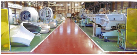
埠頭工場 ナセル製造ライン
