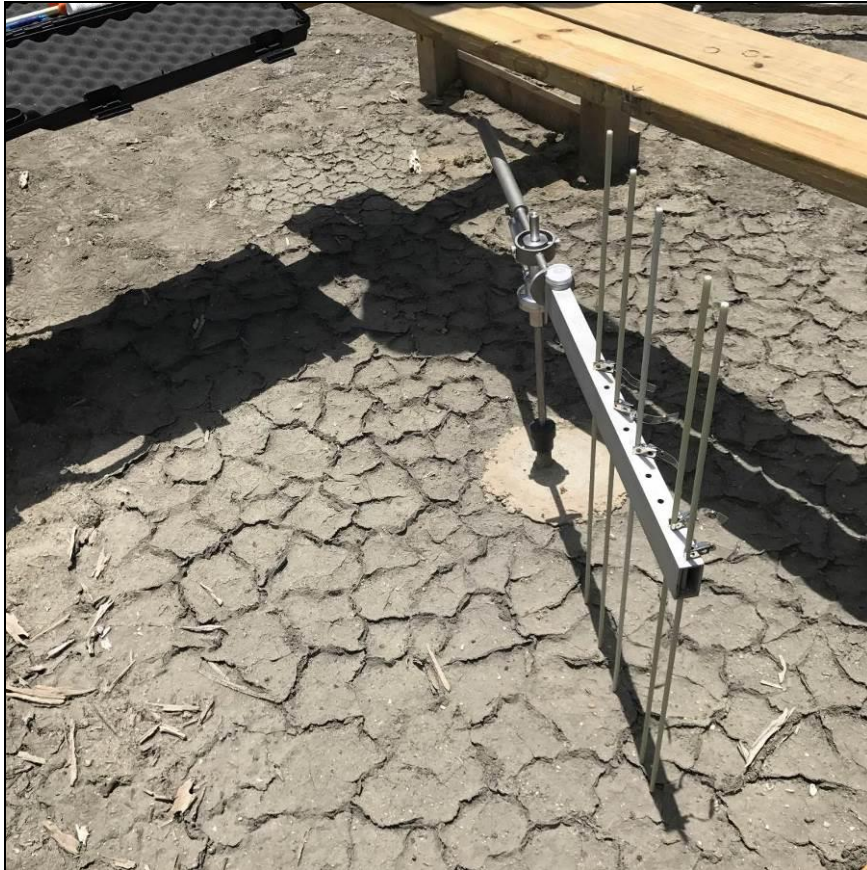
圖 3-18 架設完成的海平面上升監測點儀器
