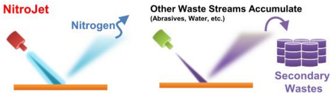
圖 10、NitroJet 工作原理示意圖和其他方法之比較
