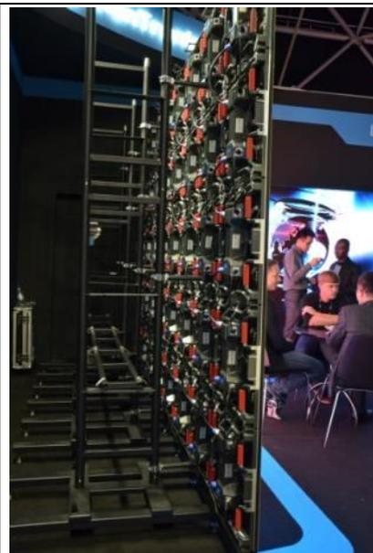
▲ 具有面板模組化可獨立更換、尺寸無限制特點之 LED 顯示器。
