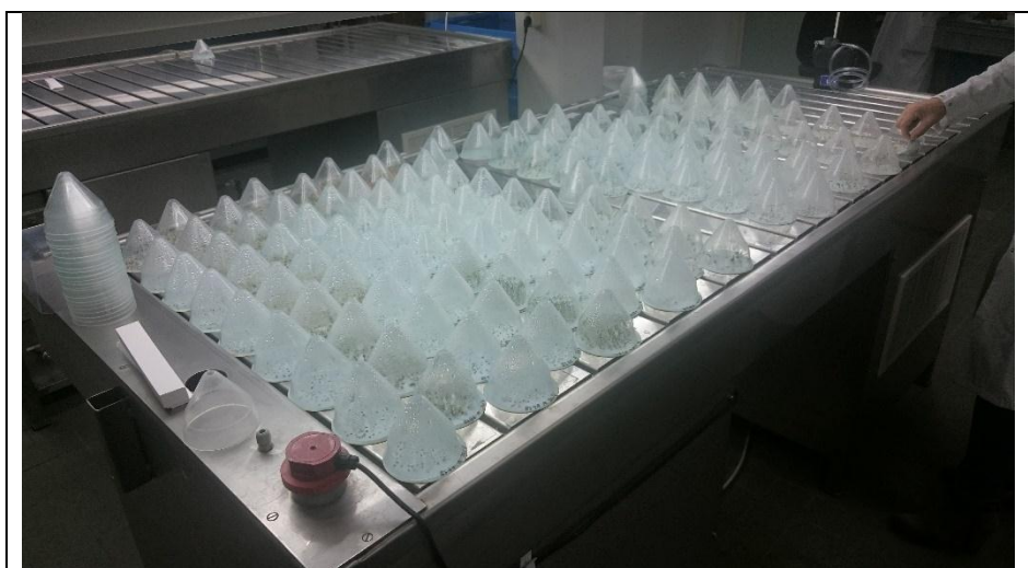
圖二十四、Naktuinbouw 進行種子發芽試驗時，20<->30 °C 變溫環使用的平臺。
