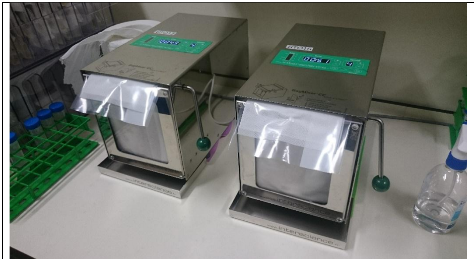
圖十二、番茄種子用鐵胃均質機(Stomacher blender)進行病原菌萃取。
