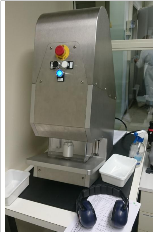
圖十九、病毒檢測前進行植體葉片研磨的捶打型機器，使用時要戴耳機以保護聽力。
