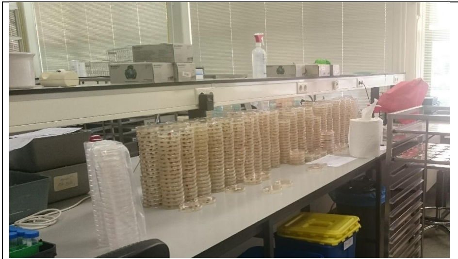
圖十六、Naktuinbouw 真菌檢測以培養與形態觀察為主。
