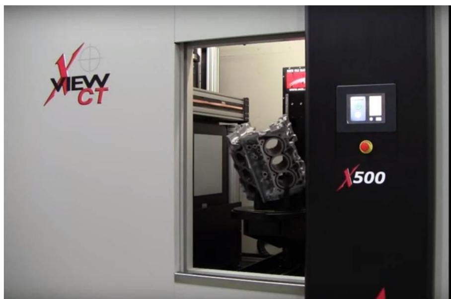
圖 3.2-1 TSB 實驗室之 X 射線檢測設備
