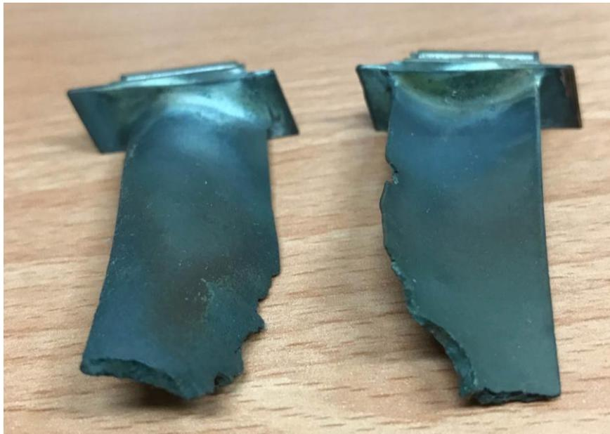
圖 2.4-13、渦輪葉片輻向斷面
