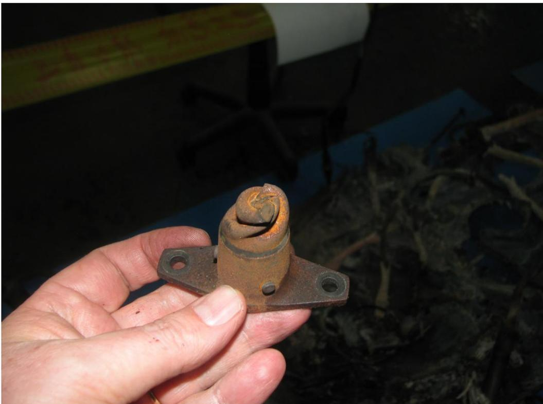
圖 2.4-14、轉動軸遭受末端動力大幅限制輸出的應力斷面及扭矩方向
