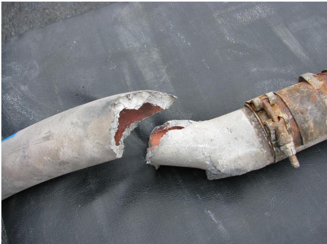
圖 2.4-16、直升機橫館受損斷面
