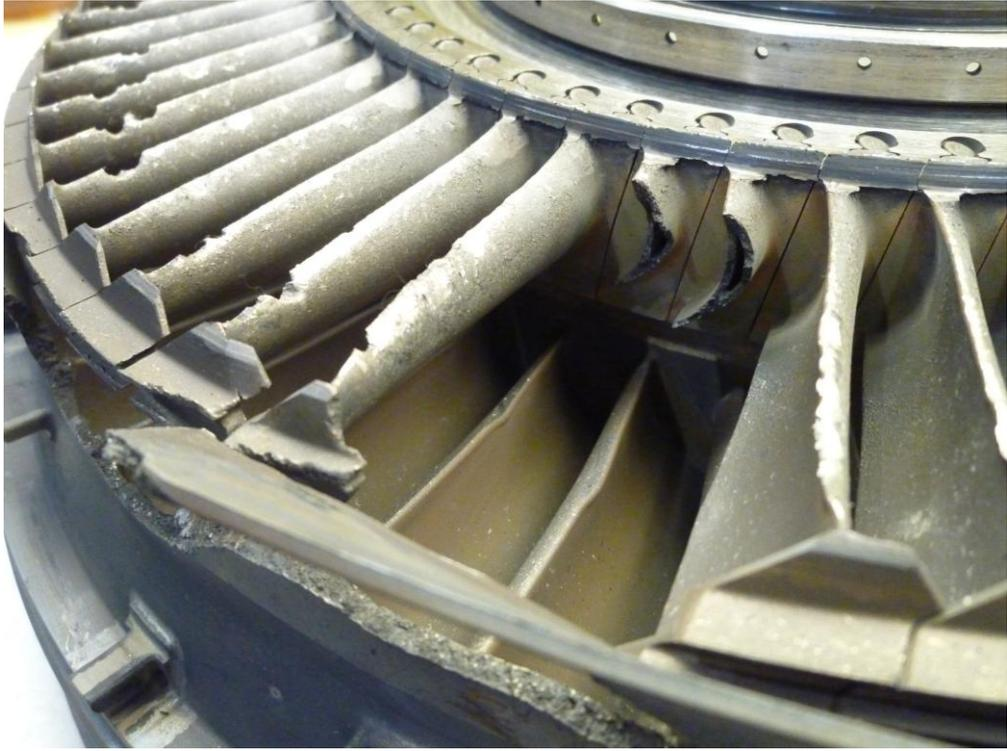
圖 2.4-12、渦輪噴嘴葉片輻向斷面
