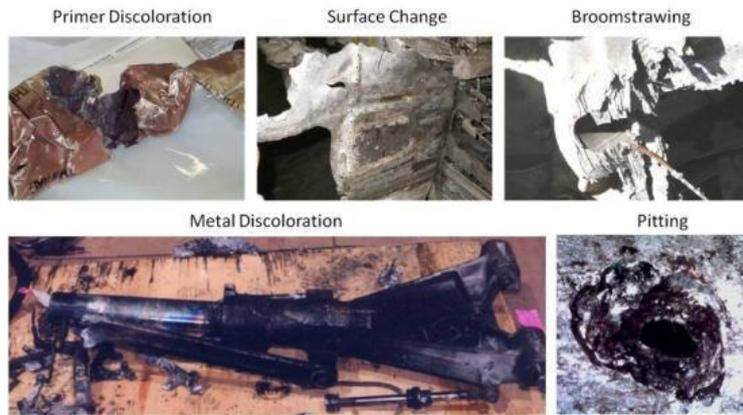
圖 2.4-5 殘骸受熱造成之損壞情形
