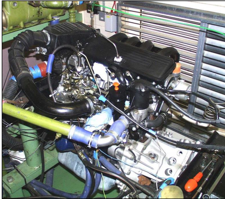
圖十四、Peugeot XUD9 測試引擎。
