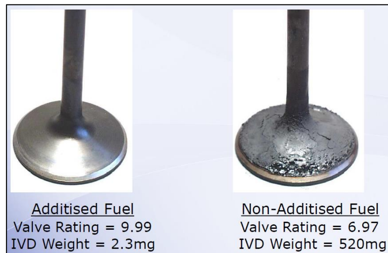
圖十、進氣閥積汙結果評估。
