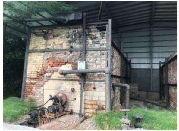
加熱爐：新津屬重油加熱避免油品凝結
