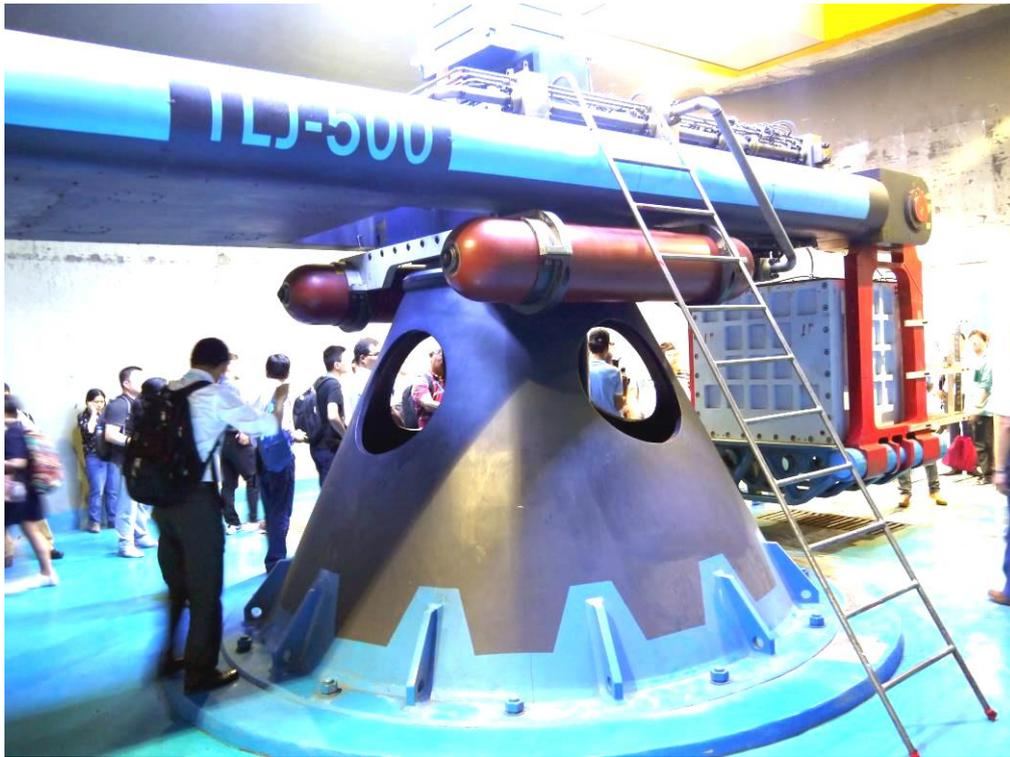
圖 6、大型岩土離心機系統
