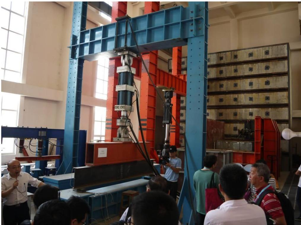
圖 8、大型地震模型震動系統(建設中)
