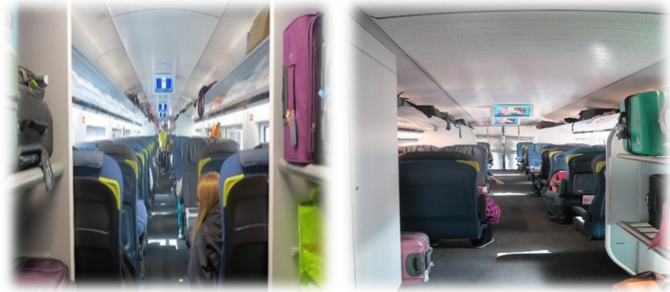
圖 14 車廂中間設置大型行李櫃
