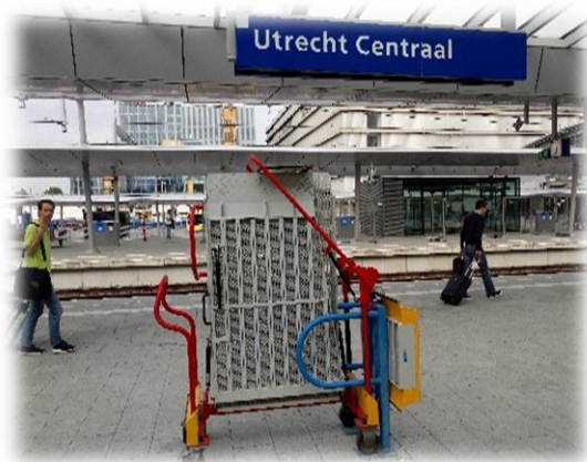
圖 18 列車與月台接駁車之搭橋接版
