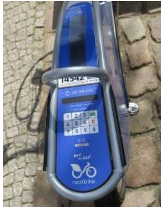
圖 4-25 可隨電動自行車移動的充電器兼計費器；該計費系統可隨車紀錄，該記費器可記錄誰使用，誰充電，充電多少時間。車上配備有記費器即可全國到處騎，不受地點限制。事實上，目前電動車計費及充電器是研發重點。
