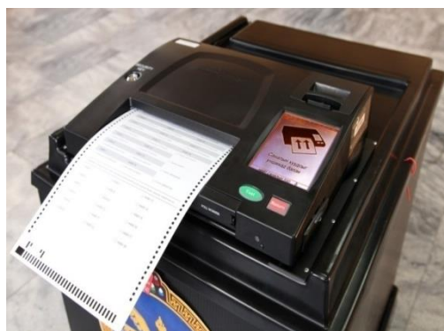
選票掃描系統的選票投入口及操作介面
