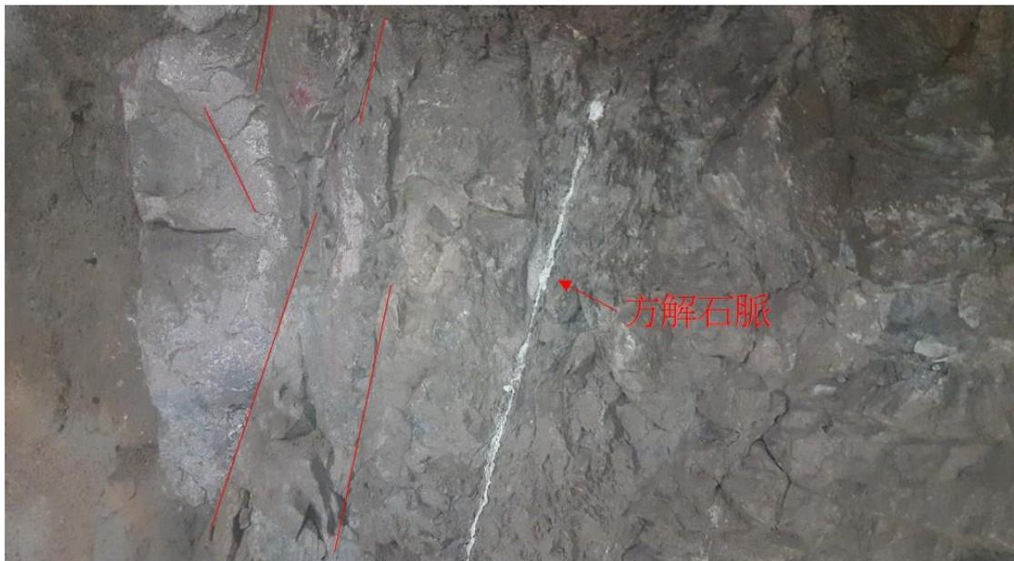
圖 37 試驗坑道之裂隙分佈及填充物
