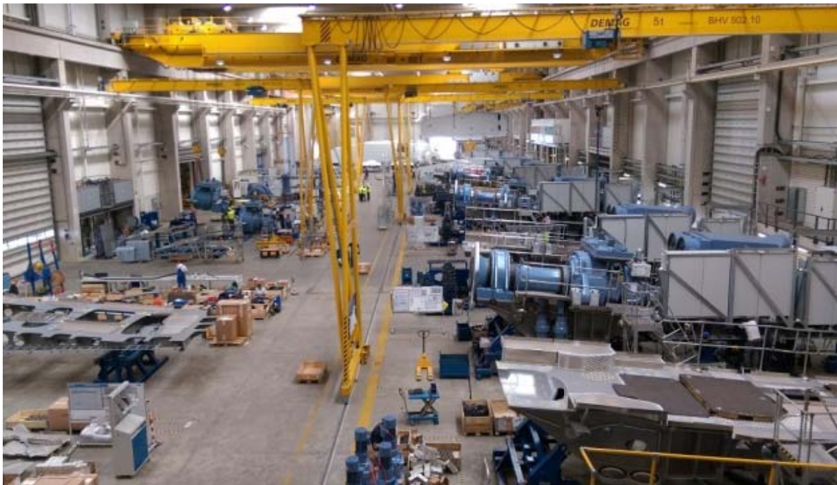
圖 2.9、SENVION 公司風機機艙內關鍵零組件裝配線現場
