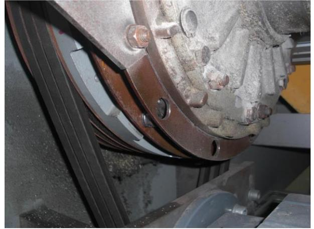
(a) JBI 伺服控制剎車，無機械元件磨損。(b) WISTA 煞車離合器，機械元件易磨損。
