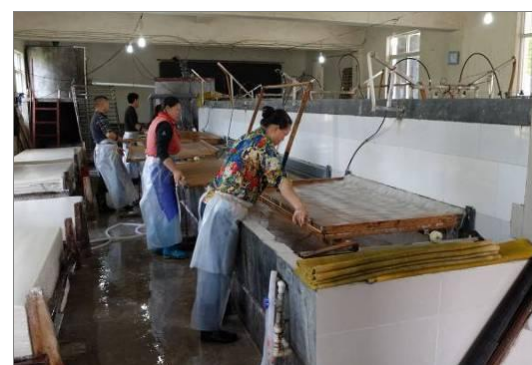
圖十二 半自動化抄紙設備可節省人力
