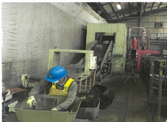
廢 LCD 電視塑膠背蓋破碎流程
