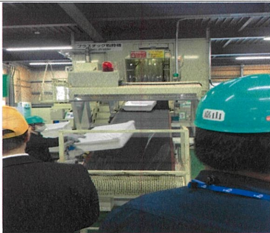
廢冰箱內塑膠物件再回收程序
