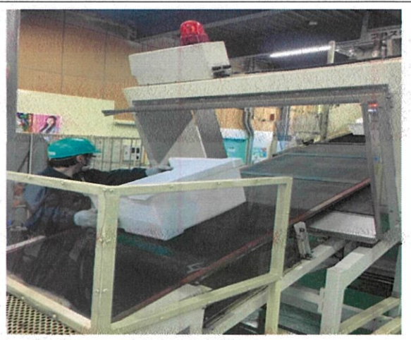
廢冰箱內塑膠物件再回收程序
