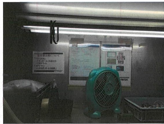
廢 LCD 電視拆解 CCFL 燈管拆解抽氣櫃
