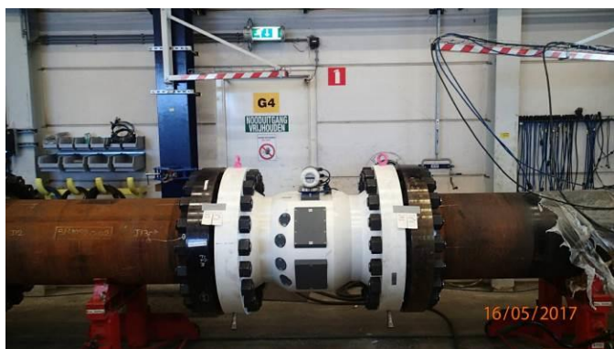
說明：SICK USM (FLAWSIC 600) 實測
