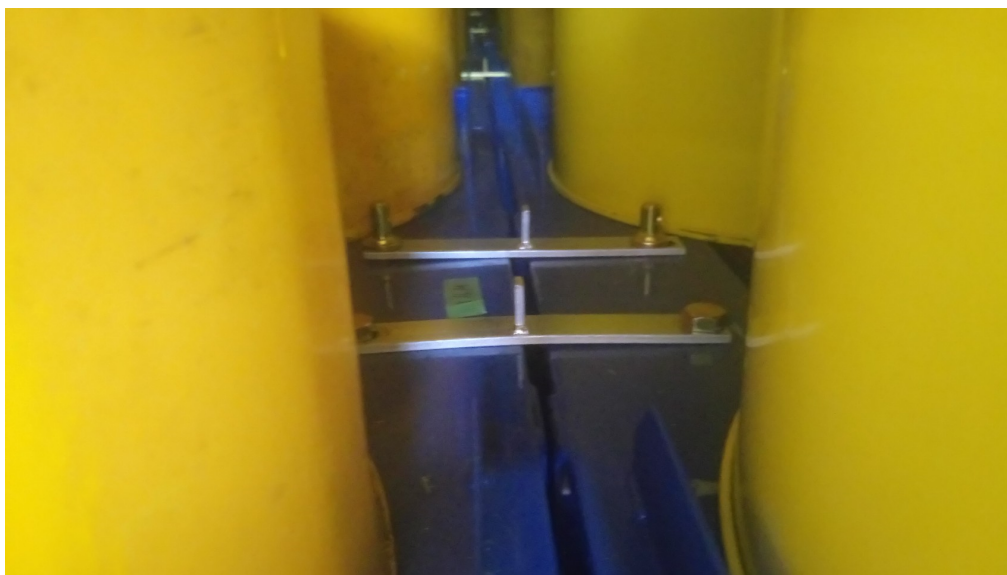
圖 18：相鄰棧板間加裝固定螺絲以避免晃動
