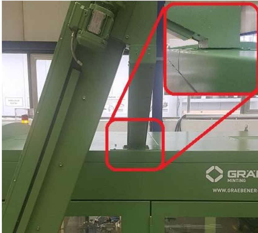
圖 7、光餅輸送機出料口與隔音罩之相對位置
