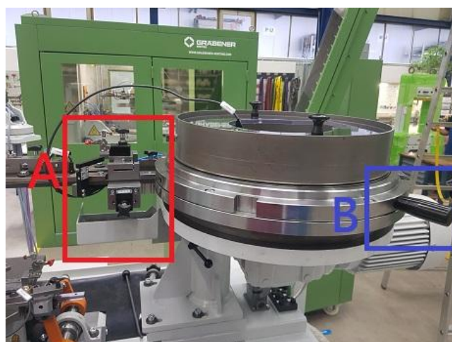
圖 5、旋轉離心式送料及篩餅機構總成
