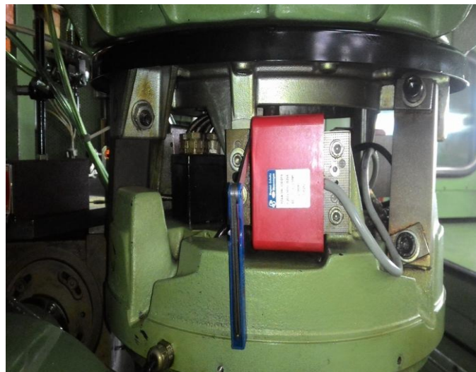
圖 12-1、用厚薄規調整電磁鐵與銜鐵間隙為 2.5mm
