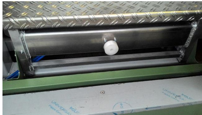
圖 4-1、左側滑門之氣壓頂桿
