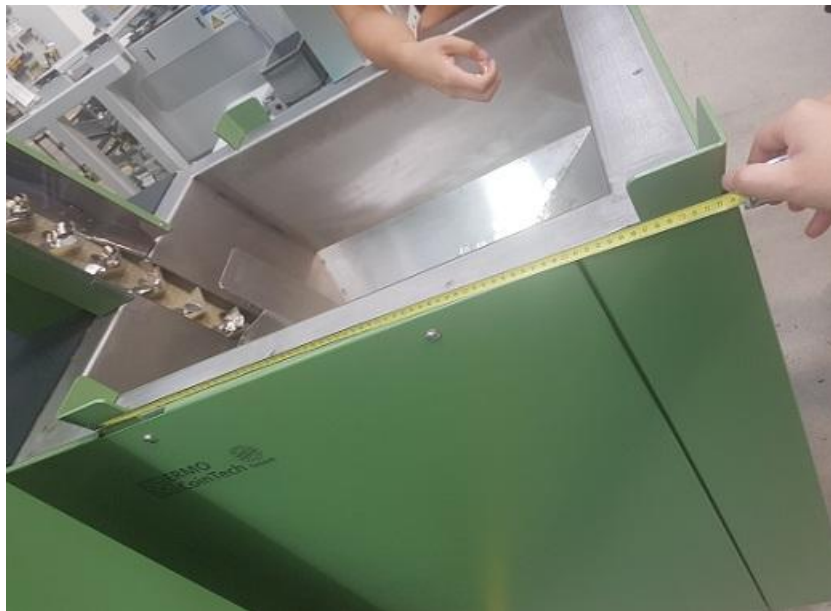
圖 3、測量光餅輸送機突出隔音罩之距離
