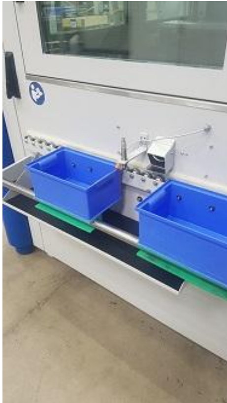
圖 13、省力之倒幣機構
