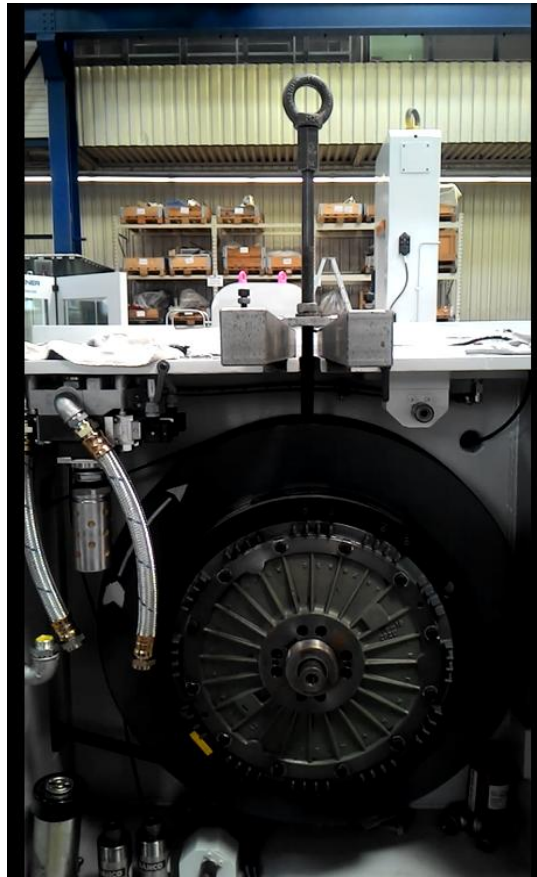
圖 10、示範飛輪拆卸
