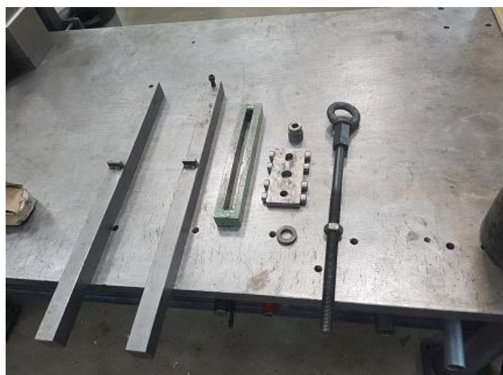
圖 10-1、飛輪拆卸輔助工具
