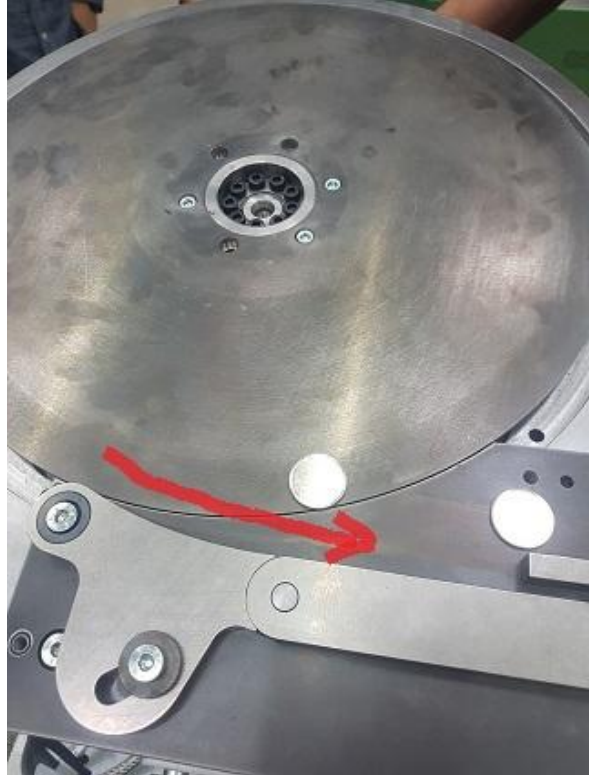
圖 5-2、紅色箭頭標示光餅受到離心力牽引的運動路徑
