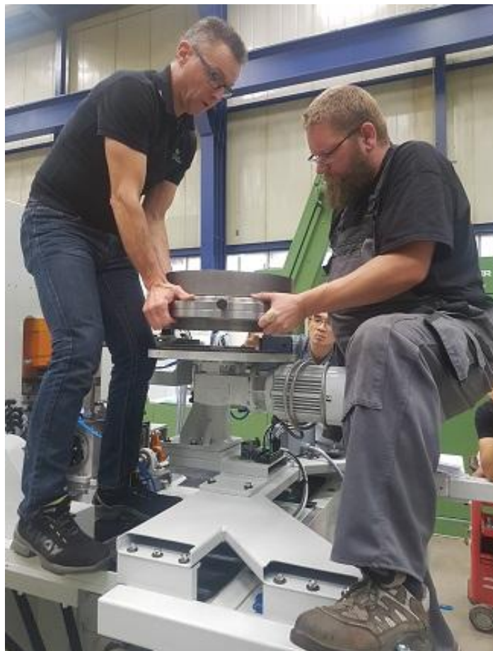
圖 5-1、拆卸旋轉式送料機之轉盤
