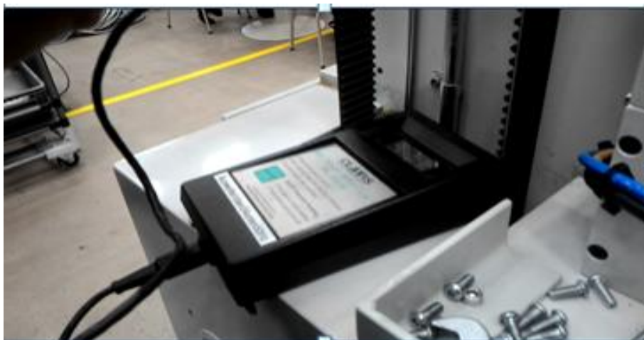
圖 9、使用皮帶張力計 (Belt tension meter) 調整時規皮帶
