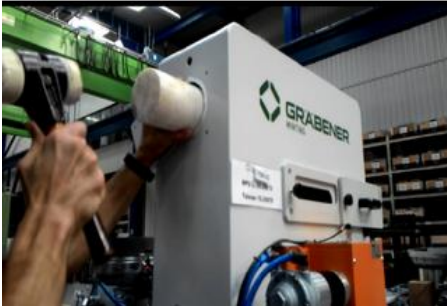
圖 8、使用輔助工具將退幣軸由左側培林敲出
