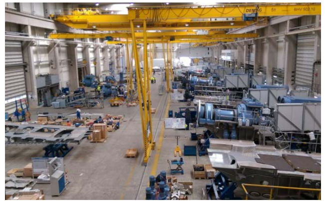
圖 10 SENVION 公司風機機艙內 關鍵零組件裝配線現場
