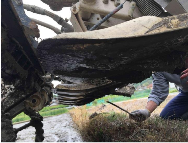
圖 26. 直播機所設計的覆土裝置，在播種後可在種子表面蓋上薄土。
