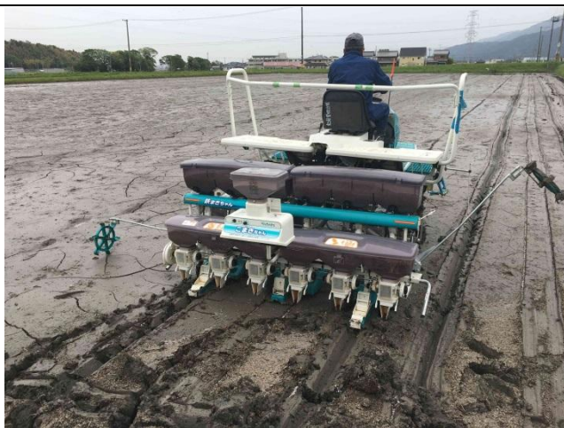
圖 19. 掛載於直播機上的稻種桶(下)、除草劑桶(中)、肥料桶(上)，三者可在田間播種時同時施用。
