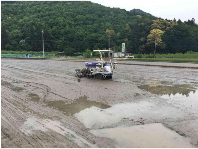
圖 24. 過氧化鈣稻種直播系統之田間直播機，為井関農機株式會社製造。
