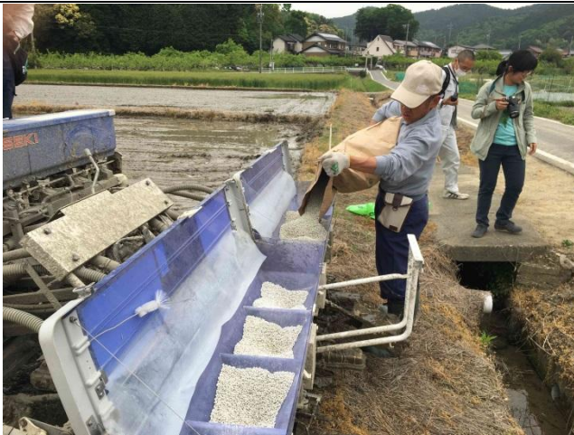
圖 25. 井関農機之直播機掛載的肥料桶，可於播種同時施用肥料。圖為正在補充肥料。
