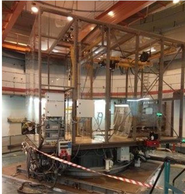
圖 二十四、DR-3 爐內切割作業與監視系統工作站
