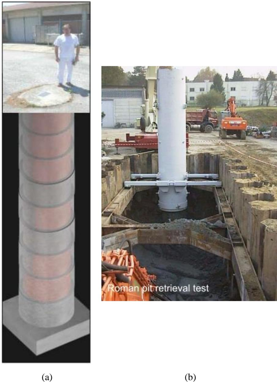
圖 二十、歐盟共同研發中心 Ispra (a) Roman Pits 示意及(b)取出測試
