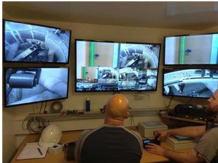
圖 二十五、DR-3 爐內鋁襯切割操作控制室
