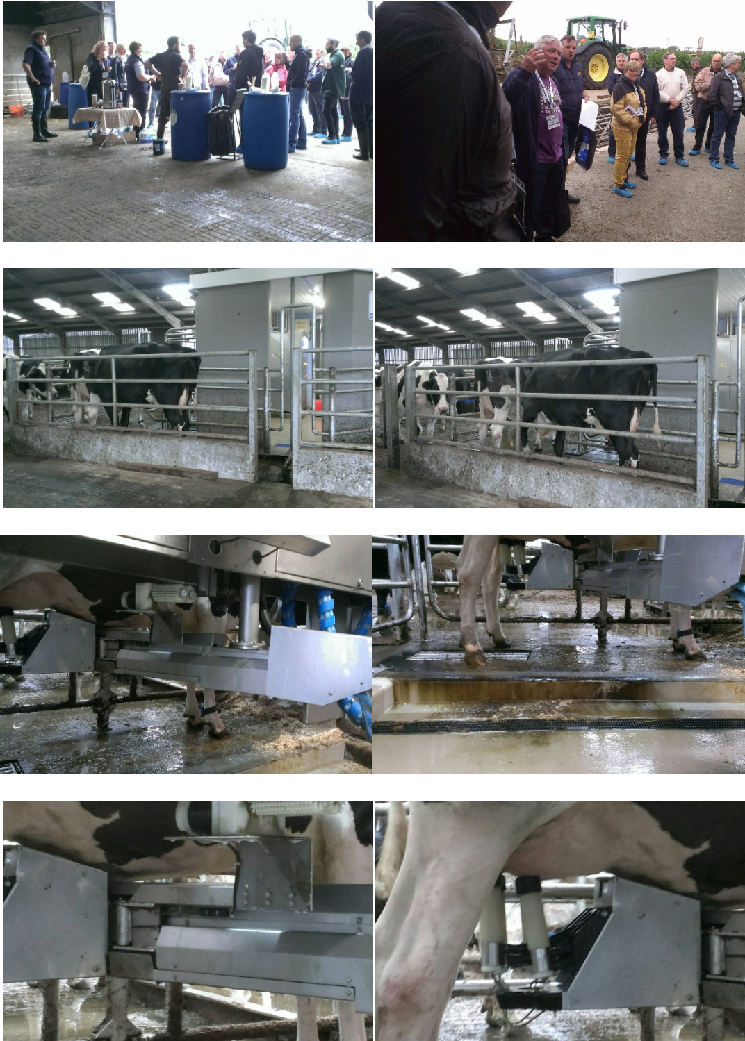
圖 3. 參訪英國Parked農場及榨乳機器人，全場約100頭泌乳牛僅由2位工作人員管理，泌乳牛會依序排隊完成清洗、榨乳及消毒等步驟。
