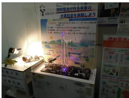
以太陽光電解水製氫，氫儲存後發電 模型示意圖
