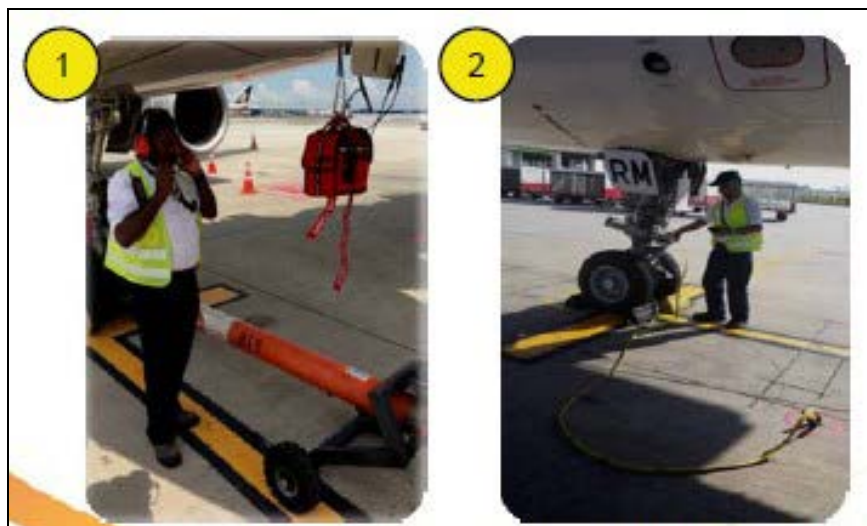
▲ 樟宜機場接靠機人員使用無線耳機與航機三點接地
