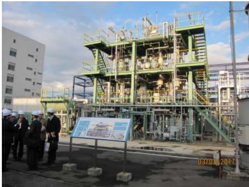
圖 16 千代田化工所有機氫化物吸脫附試驗設備外型
