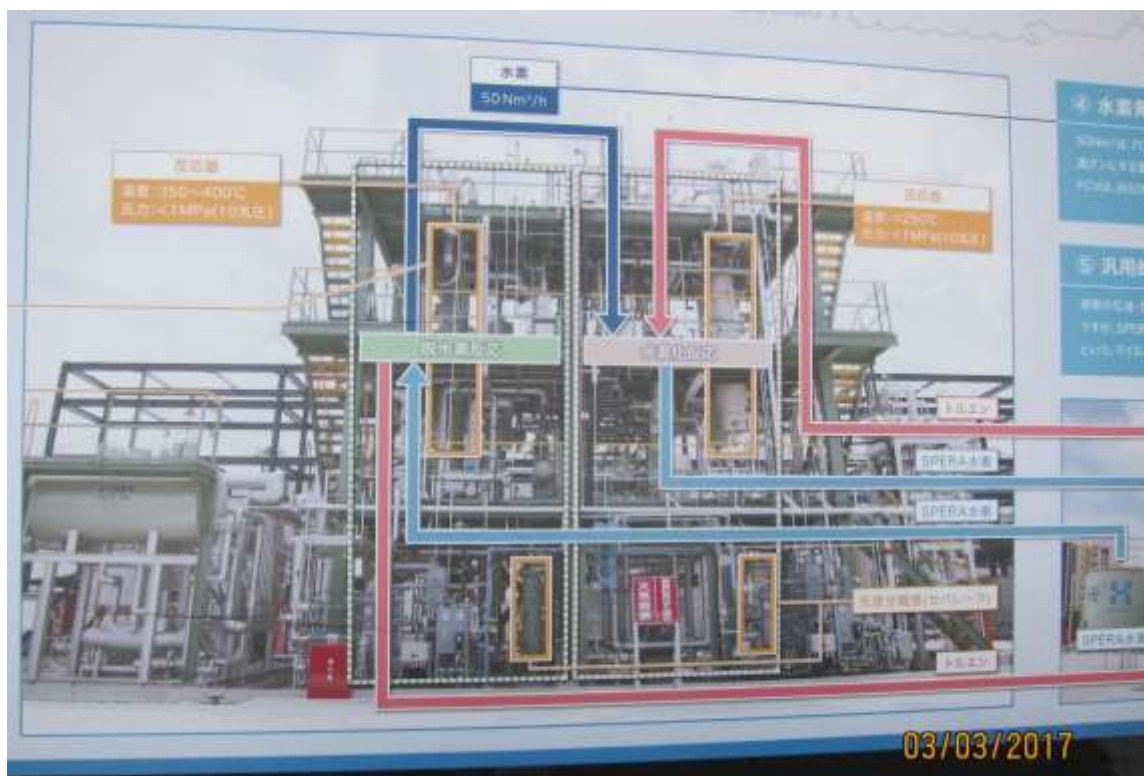
圖 17 千代田化工所有機氫化物吸脫附試驗設備構造說明
