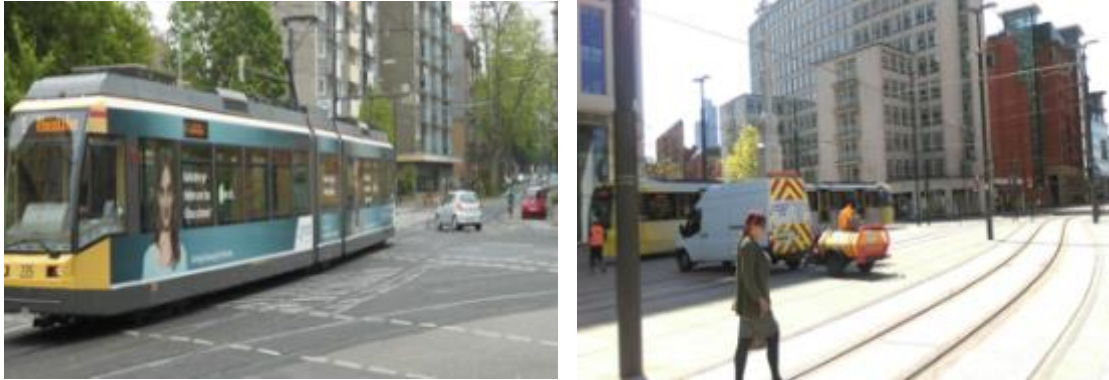
圖 3.4.4 輕軌系統行車路線未能與其他平面交通工具隔離
