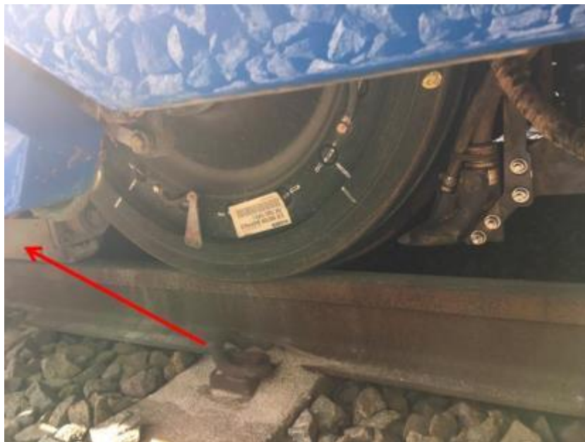
圖 3.3.16 英國 Sheffield SuperTram 緊急煞車塊貼近於軌面
