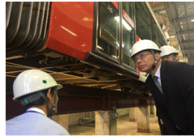
重要設備移設車頂以降低底盤
