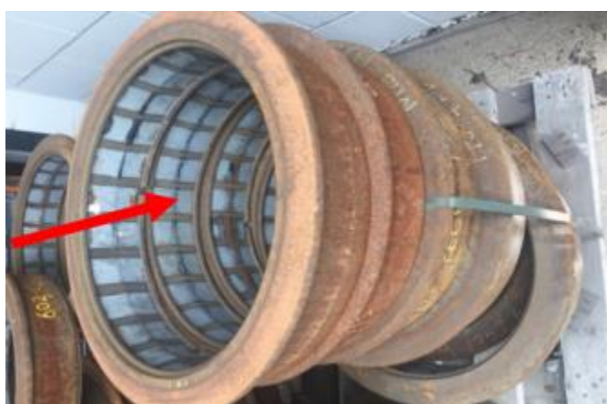
圖 3.2.10 輕軌車輪輪筐內之緩衝橡膠
