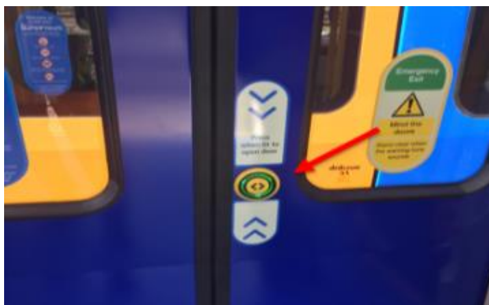
圖 3.2.9 法國 Mulhouse Tram-Train 車門(紅色箭頭處為開門按鈕)
