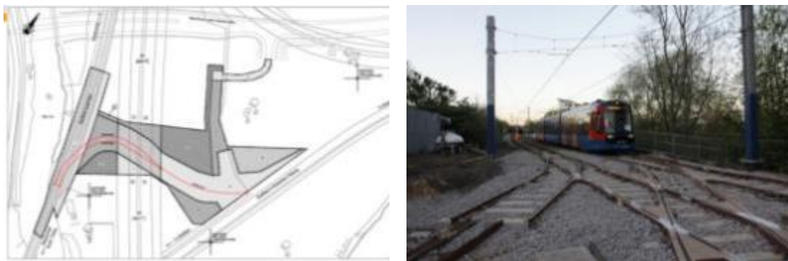
圖 3.5.9 Sheffield (A)現有路線銜接示意圖(B)Tramway 路線出岔延伸
