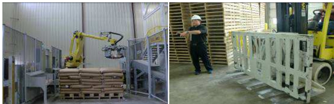
Scoular 自動化裝袋封口堆積生產線
