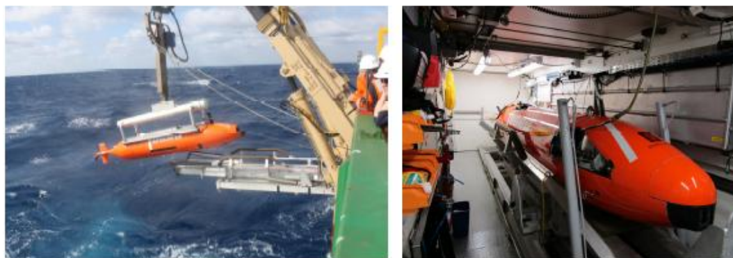
圖 3-3 Kongsberg Hugin 4500 自主式水下載具作業（取自 ATSB 簡報資料）
