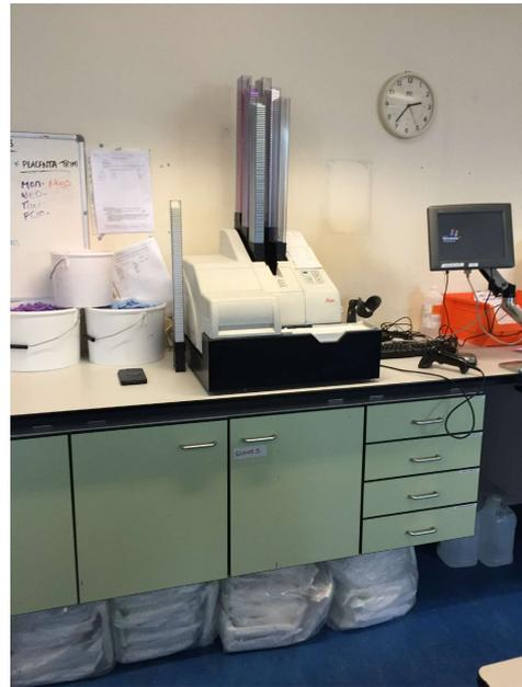
圖三十一、蠟塊打印系統
