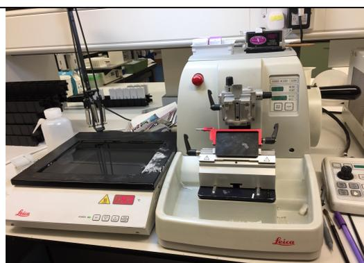
圖三十七、Rotor 式的切片機
