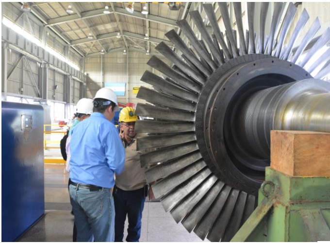
照片 16-3 地熱機組汽機葉片
