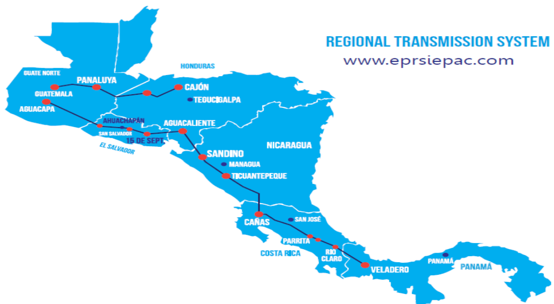
圖4 薩爾瓦多鄰近國家輸電系統連接圖
