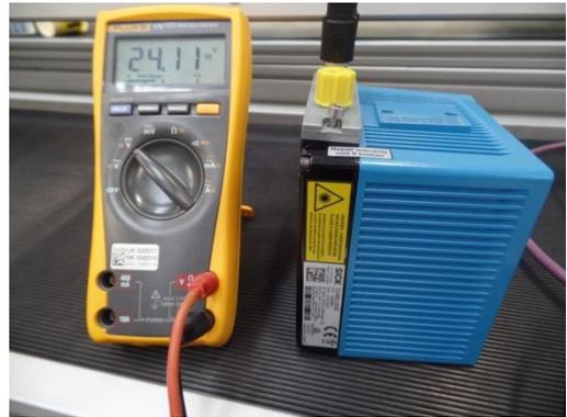
電壓測量(24.11V)
