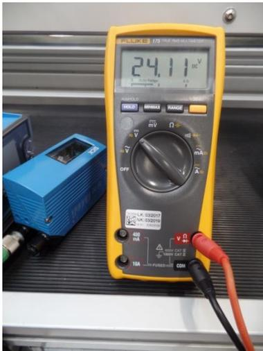
電壓測量(24.11V)
