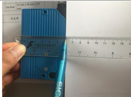
測量設備寬度(61mm)
