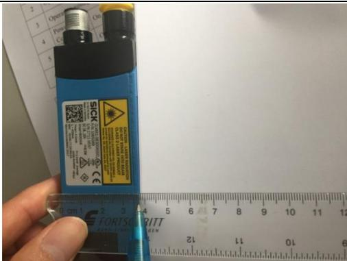
測量設備高度(38mm)
