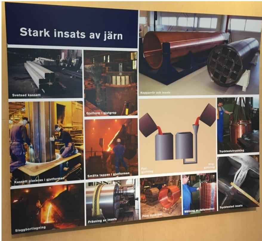
圖 37、內襯鑄鐵的製作方法
