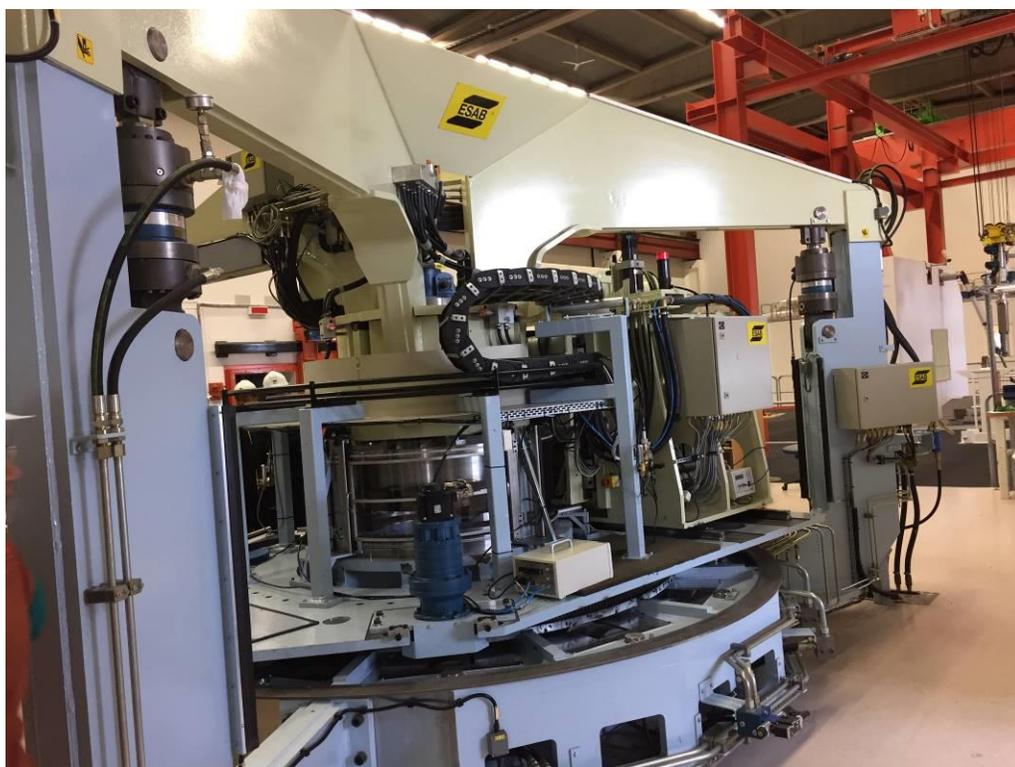
圖 36、摩擦攪拌銲接設備
