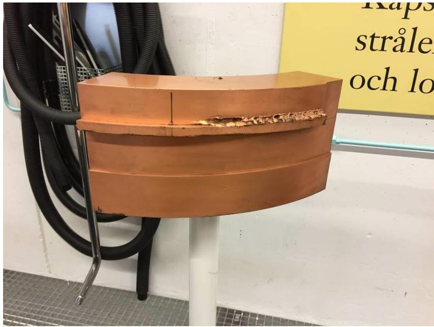
圖 33、使用高真空電子束銲接(High Vacuum Electron Beam Welding, EBW)技術
