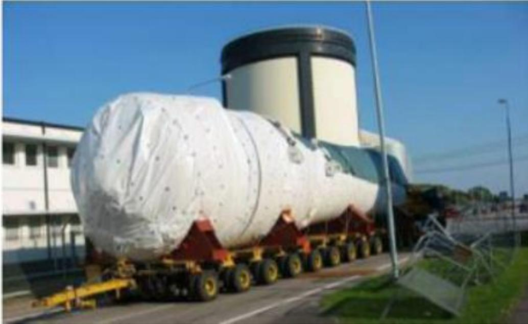
圖十八、瑞典 Ringhals 電廠委託處理 9 座蒸汽產生器(每座 310 噸)
