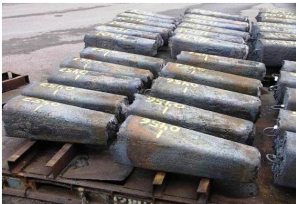
圖十九、廢金屬組件經切割除污熔煉後產出的金屬錠塊
