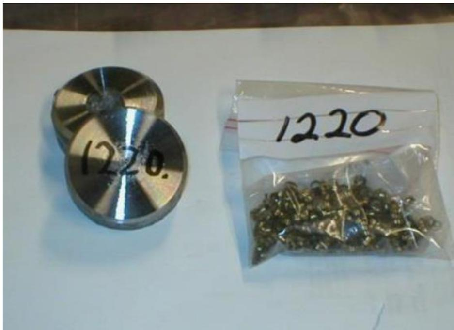
圖二十、熔煉錠塊同步取樣進行核種分析以保持可追溯性
