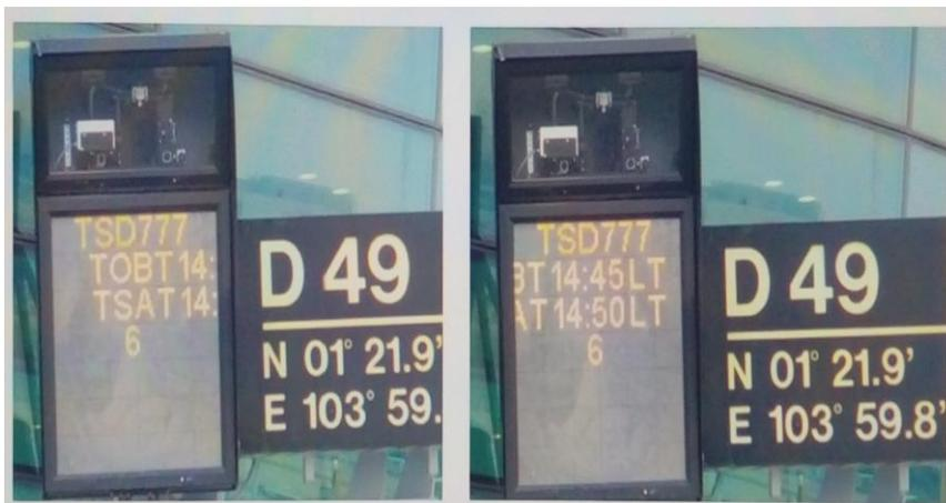
圖 5. 樟宜機場 ADGS 系統，駕駛員可從畫面讀取 TBOT 及 TSAT (資料來源：課程投影片)
