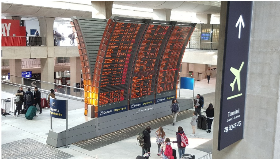
圖 7.25 戴高樂國際機場FIDS看板，配合旅客仰頭視線，設計為弧形
