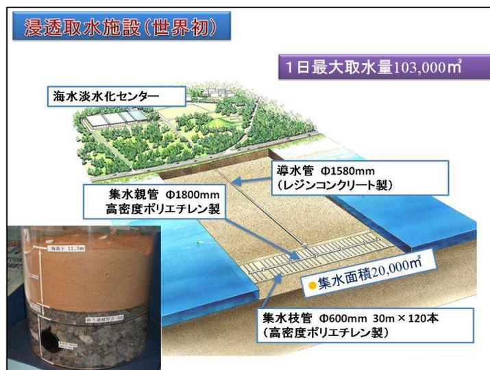
圖 2.5-20 浸透式取水設施構造
