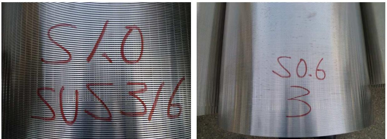
圖 2.3-30 準備出貨之不同間距過濾器(孔隙間距 1.0mm 及 0.6mm)
