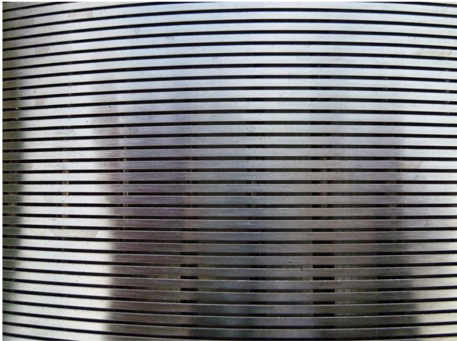
註：那賀株式會社生產的過濾器顯示其開孔率大，鋼線與骨架均經電焊頗為堅固，且材質可選不銹鋼或不銹鋼再予鍍鋅加強其耐久性。
