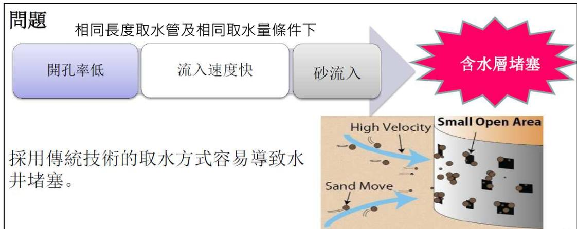
圖 2.3-8 伏流水設施含水層水流動速度愈快愈容易帶動砂粒
