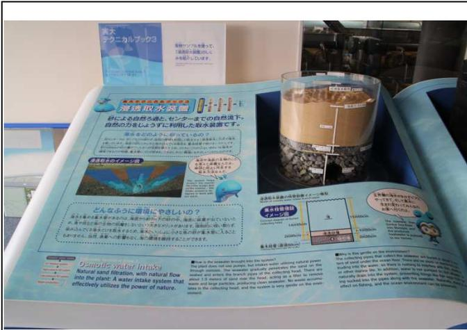
圖 2.5-22 浸透取水系統之模型說明
