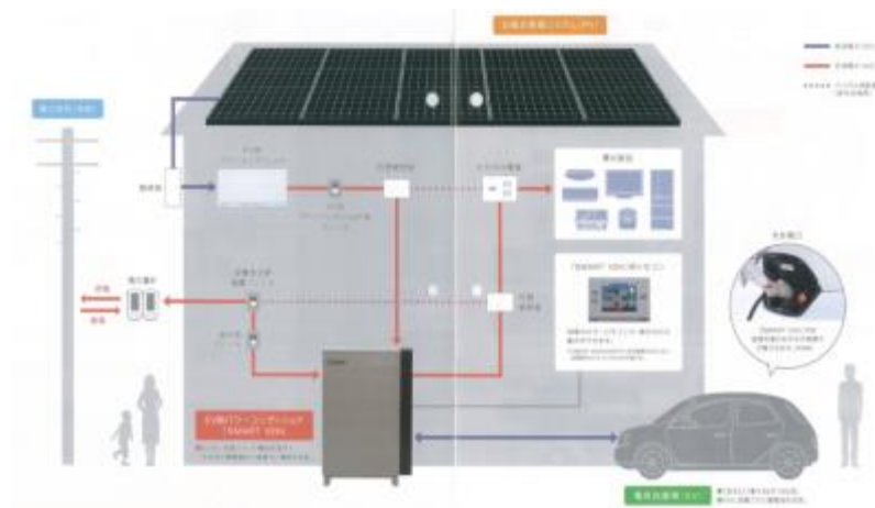
圖 13. Mitsubishi Electric 公司 SMART V2H 蓄電池應用圖示。
