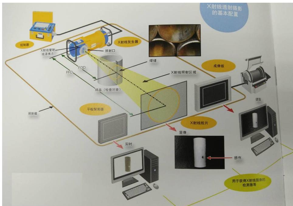
圖 5 放射線照像檢驗之數位式顯像方式
