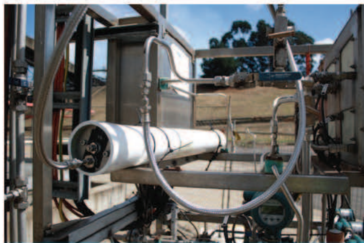
圖 5：CO 2 CRC H3 在薄膜模組工廠現場試驗
