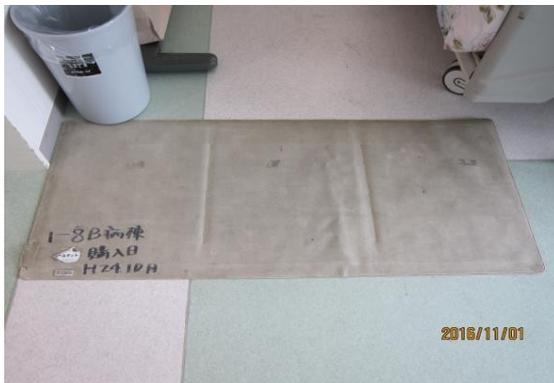
圖 83 離床警示器設備-放地面
