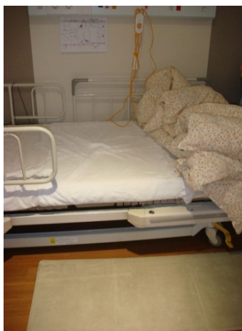
▲床邊離床報知器
