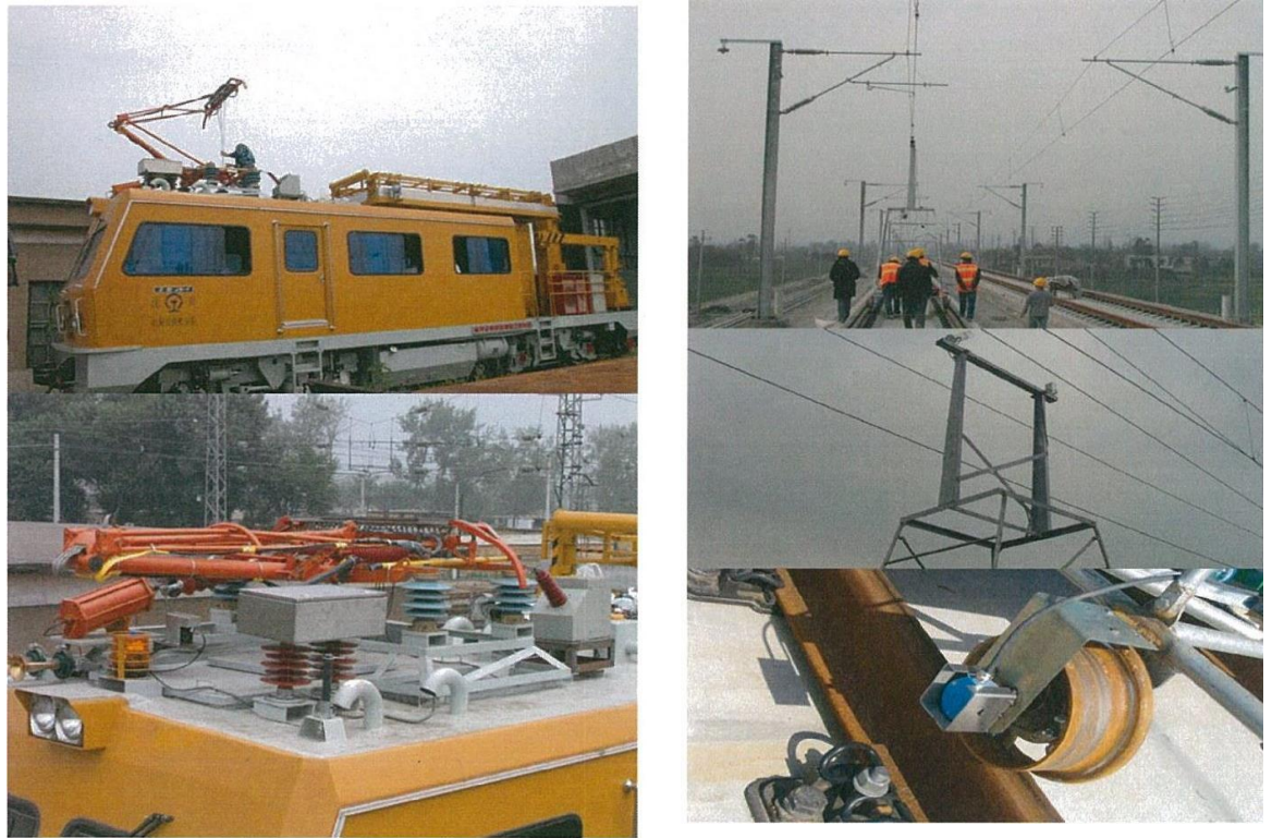
圖 3-6 電車線檢測儀器安裝於電車線維修車及軌道梯車上
