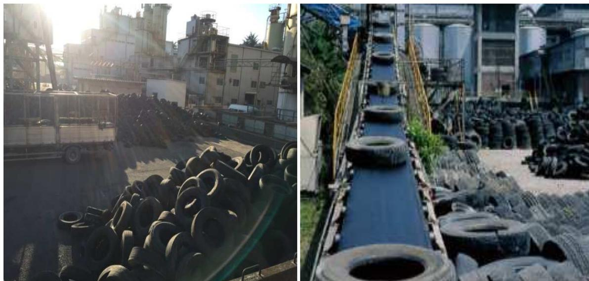
圖五 廢輪胎堆置及進料設備
