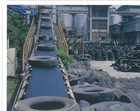
廃タイヤは丸ごとロータリーキルンへ投入し、年間約1万トン (普通乗用車用125万本分)を補助燃料として活用しています。
