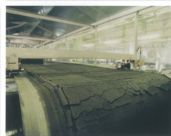
ばいじんは水洗設備で塩素を除去し、セメント原料と して資源化しています。
