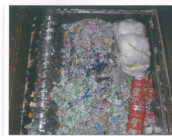
廃プラスチック類は破碎後ロータリーキルンへ投入し、 年間約2万トンを補助燃料として活用しています。
