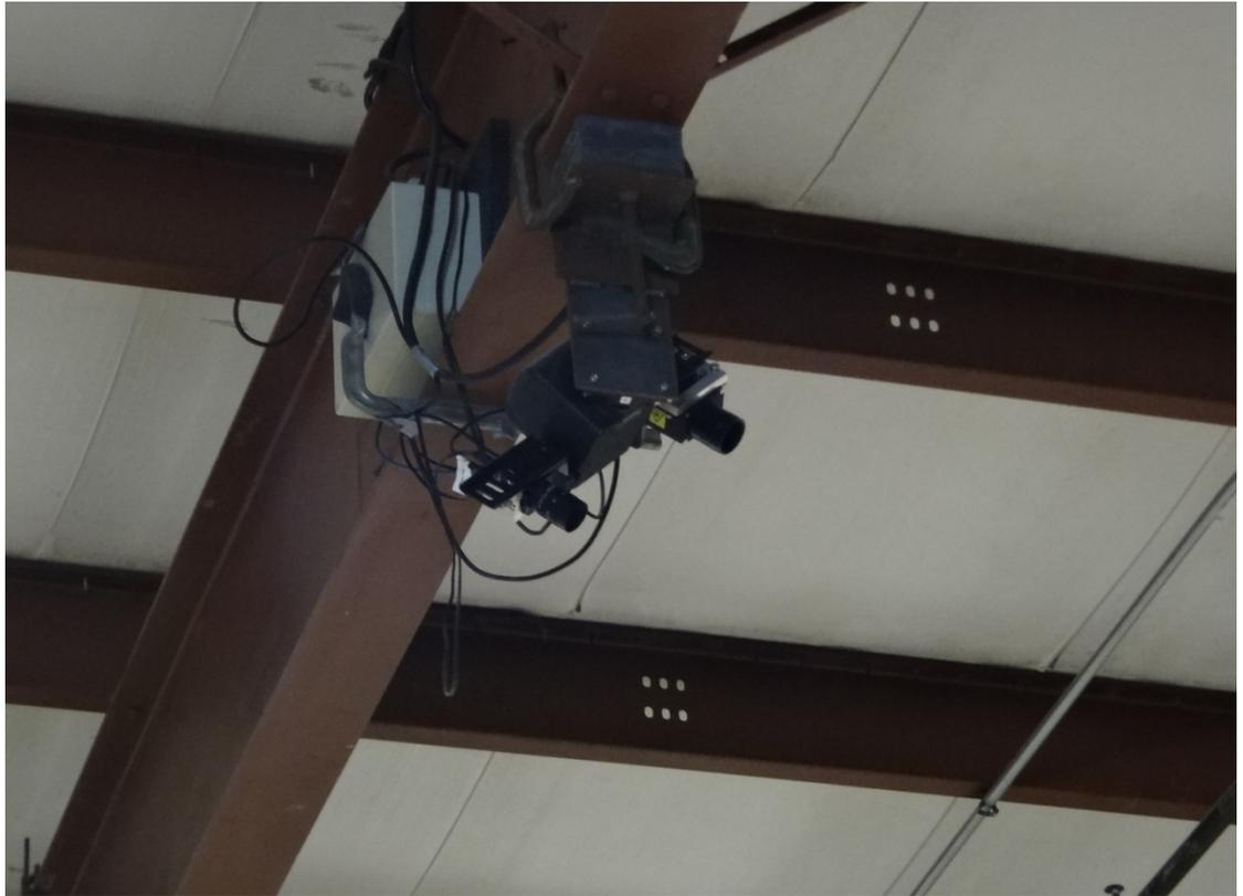
照片 22 電廠冷卻水進水口泥沙沖淤試驗雷射地形量測
