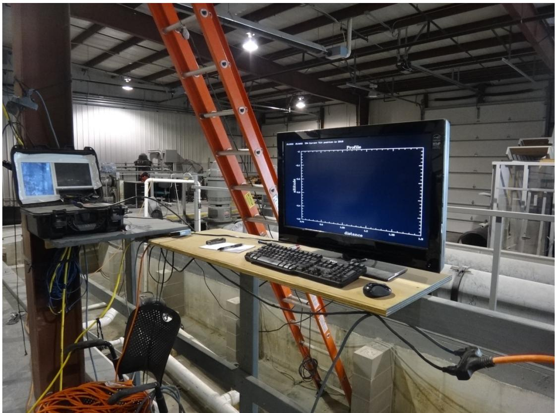
照片 23 電廠冷卻水進水口泥沙沖淤試驗雷射地形量測
