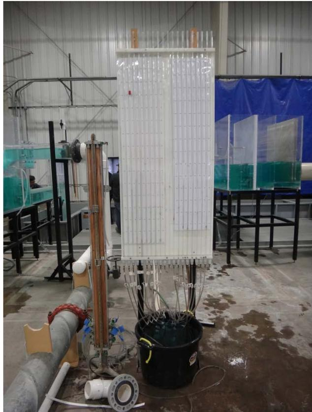
照片 7 倫敦排水結構物水工模型測壓管量測壓力
