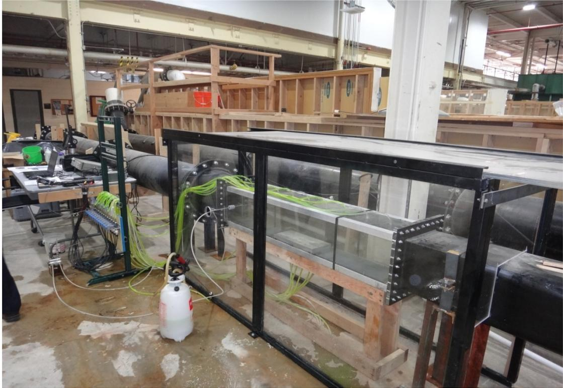
照片 54 皮托管於水工模型布置之試驗
