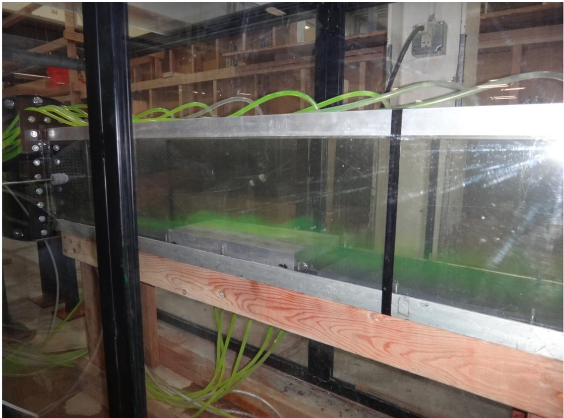
照片 55 皮托管於水工模型布置之試驗
