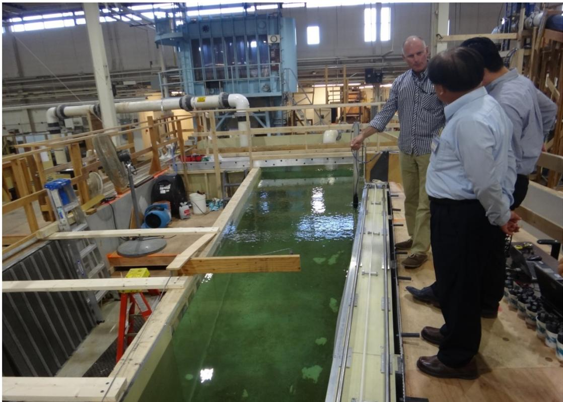
照片 53 3D流速計於水工模型之動態量測
