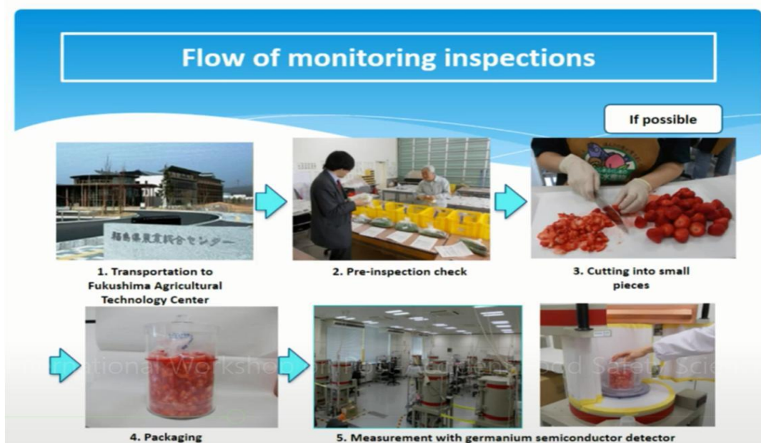
圖 4 福島縣農業綜合中心農林水產品輻射殘留物質檢測流程
