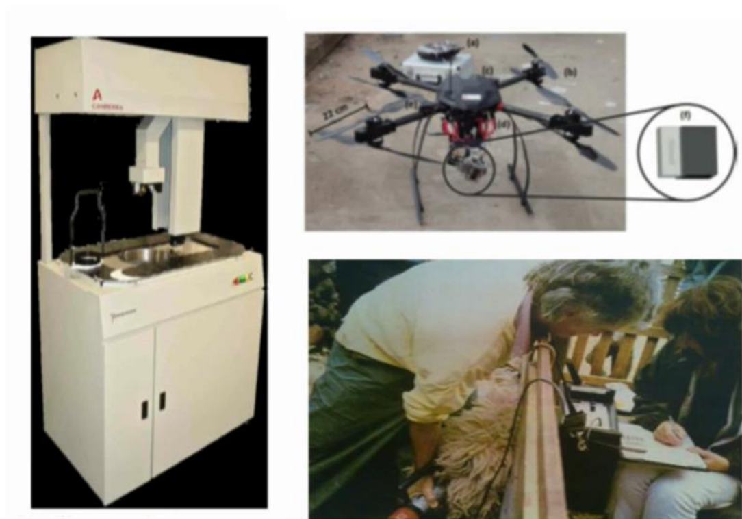
圖 10 自動加馬能譜分析儀及改良式現場監測設備
