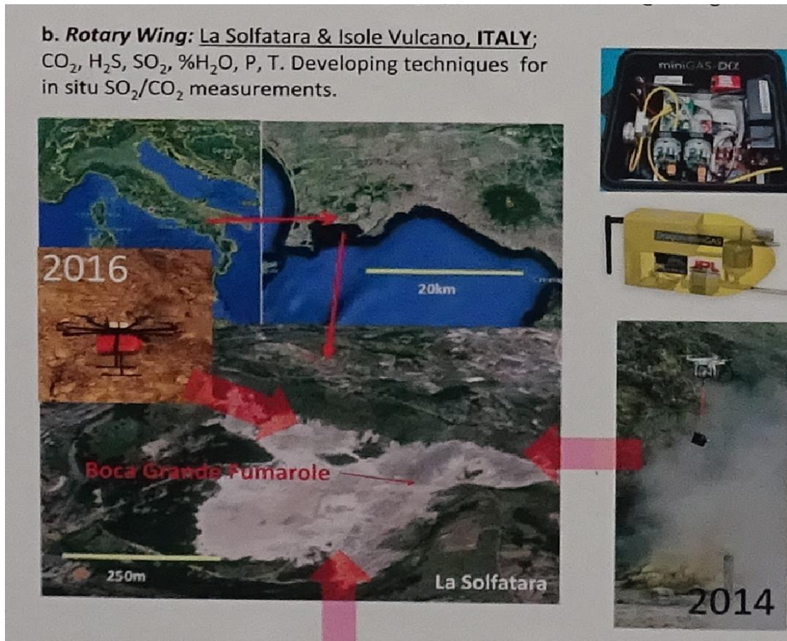
圖 12 美國國家太空總署噴射推進實驗室進行活火山地區氣體採樣使用的無人機設備。
